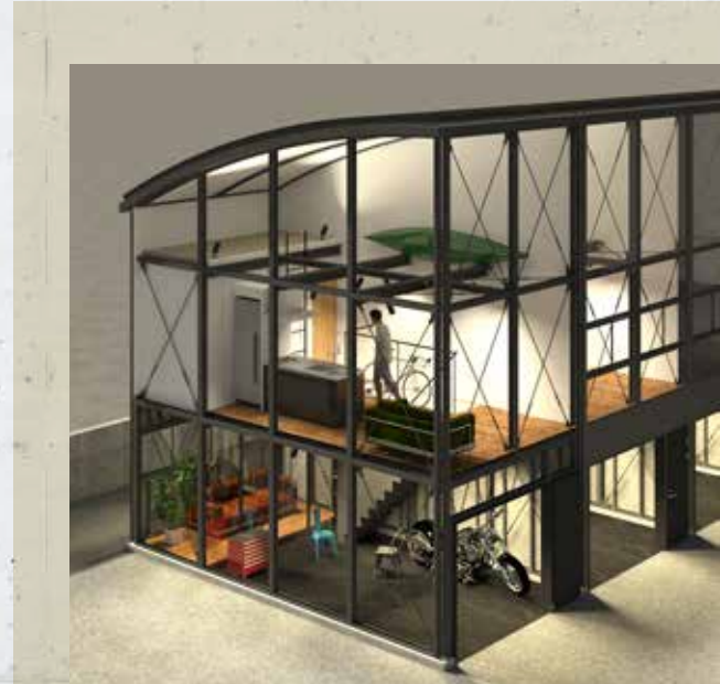
ガレージアパートの骨組みCG。2Fの豊かな空間性に注目。米軍の格納庫用として開発された屋根素材「Rスパン」のふくらみが必然的に作り出す豊かな空間です。露出する鉄骨の梁を利用して自分なりの立体的なディスプレイも楽しい。住む人を元気にしてくれます。
