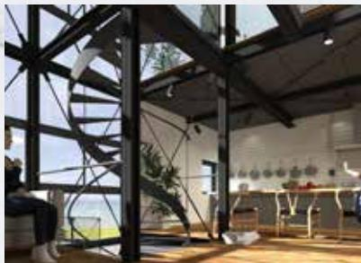
生活の一部となる屋上空間を可能にするのは世田谷ベースの建築時にも採用された曲面屋根「Rスパン」です。これにより豊かな吹き抜けと屋上空間を提供しつつ、プライバシーの確保もしっかりと配慮。BBQグッズの収納も完璧です。写真上はリビングやダイニングからも屋上を感じられることがよくわかる内部イメージ。スキップフロア（フロアの高さを半階分ずらしながら連続する層を構成する建築方法）を採用した新しいタイプのバルコニーといえる考え方です。キッチンの壁面は外壁と同じガルバリウムを用いてみました。
