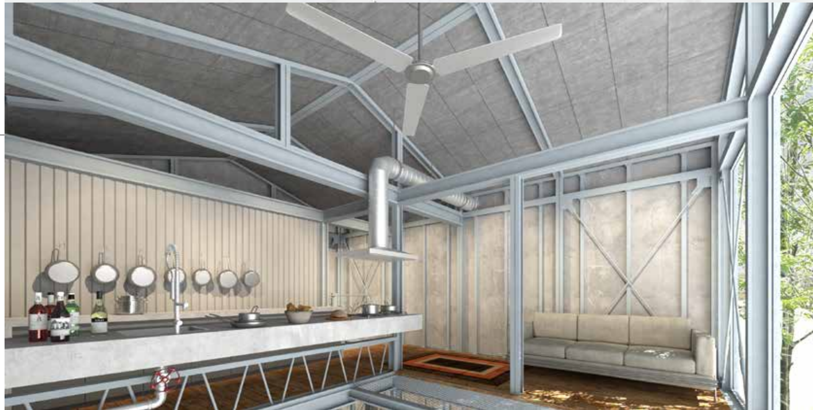
給体塗装焼き付け=パウダーコーティングの鉄骨で構成された吹き抜け空間。今回はブルーグレー色で表現しています。キッチン背面の壁にガルバリウムの外壁材を貼れば、さながらコンテナのイメージを楽しむこともできます。まるでスニッファーや演マイクのような探偵ドラマの世界観です。
