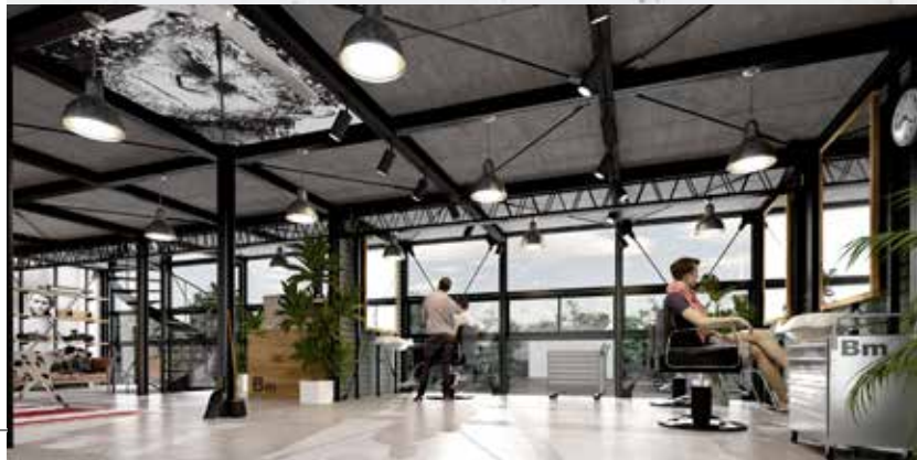
メンズサロンの内観CG。デイトナハウスの特長であるつや消し黒の鉄骨フレームを利用して、オリジナルのカット台を製作する予定です。鉄骨フレームの内部にはガルバリウム鋼板の壁面を施した逸品。グリーンとのコントラストも絶妙です。スパンを飛ばすためのトラス梁(ジグザグ鉄筋の梁)が、空間のアクセント。
