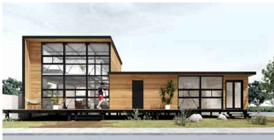
出雲ですでに鉄骨製作過程に入っている実施物件のCG。1Fの床が地上から約60~80cm浮かび上がるのが最も美しい。伸びやかな庇のラインがこのデザインの信条。庇の見付や破風板が厚くなるとデザインのバランスが崩れるので、要注意なのです。
