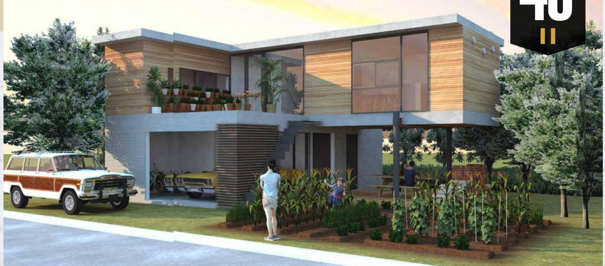
巷では最近、立方体のような箱型の住宅が流行っていて、色々なハウスメーカーがどれも同じような四角の家を提案しています。建築はその4つの角を構造体にする必要があるため、一辺の距離が短い小さな立方体の家ではコーナーとコーナーの中央のワンスパンしか開口部にできません。したがって、その開口部の連続性も表現しにくく、開放的な空間を構築するのが難しいのです。となると結局必然的に旧来のリビングルーム中心主義に留まってしまいます。そこで外部に対する解放感を最大限発揮するために、今回のプランでは1階と2階を積み上げた普通の総2階の家ではなく、立方体にプラスαした構造の2階部分を90度回転したレイアウトにしてみました。名付けて「ツイストハウス」です。家の2階部分を直角に回転させることで導線に奥行きが生まれ、様々な楽しい要素を創り出すことが可能
