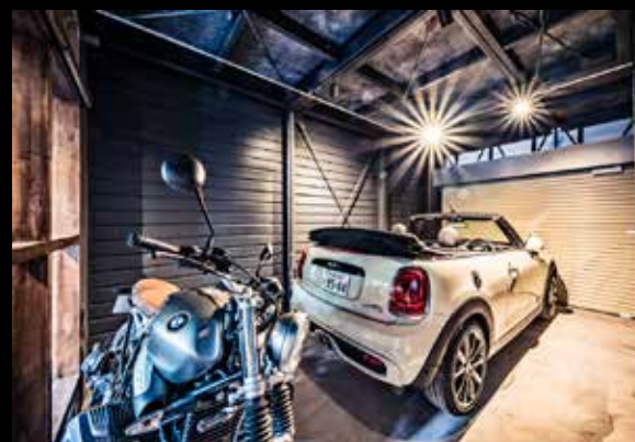
GLBのガレージスペースは、シャッター有効ワイド寸法2.48mですので、ほとんどのクルマは格納可能です。また、機械的な吸排気性能を十分取れるように配慮。排気ファンと同一性能の吸気ファンが強制的に作動して、効率よくガスを排出する機構です。あまり威勢よく吹かすことはお勧めしませんが、ガレージ内でエンジンを起動する喜びは十分満喫できるのです。
