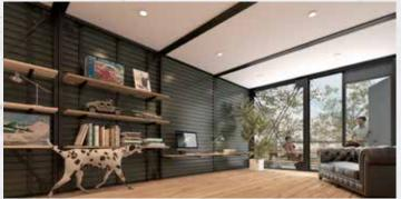
リビングルームの内観。鉄 骨の表面(フランジ)だけを 露出させた"真壁"仕様。壁 面をガルバリウムにして、デイトナハウスらしさを演 出。壁面にはデイトナハウ スオリジナルの棚受け金物 『FAS ブラケット』を装着 して、テレビ台や本棚を構 成しています。脱着式なの で場所は自由に変えられま す。「構造体なのに家具であ る」をテーマにデイトナハ ウスが開発した、スグレモ ノです。バルコニーに面し てダブルブレースのガラス 開口がこの家の顔を内と外
