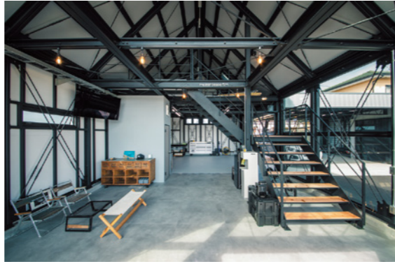
“合掌”という構造的に安定したカタチが、そのまま吹き抜けの空間性という機能と、鮮烈な外観の印象を同時に成立させている新しいタイプのデイトナハウス建築。登り梁も鉄骨パネルで形成しているところが斬新なのです。 © 設計・建築 デイトナハウス×LDK 浜松 (バランスデザイン)
